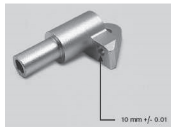
2. ábra: Alumínium öntvény-alkatrész túlméretezett lyukkal
