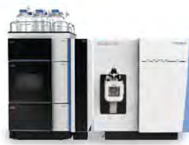
Thermo Scientific™ TSQ Fortis™ hármas kvadrupol tömegspektrométer
