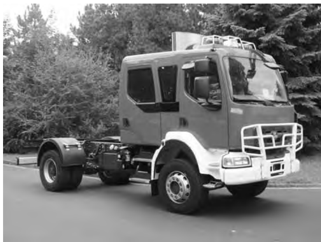
1. kép: Az R16.217AFAMD-231 típusú Kéttengelyes összkerekhajtású járóképes alváz tűzoltó és katasztrófaelhárító felépítményhez [2]
