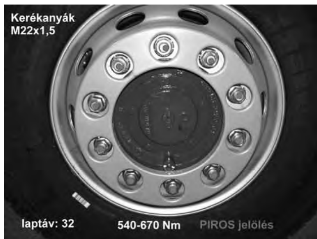
3.a kép: Fényképes műveleti utasítás: a kerékcavarokat nyomatékra húzást követően piros színnel kell megjelölni [2]
