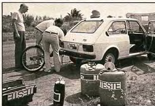
Com a instalação da quinta roda, medições exatas.
